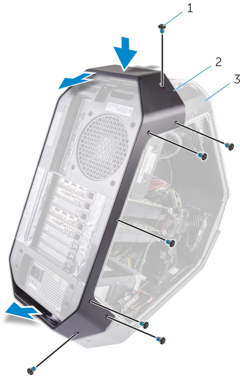
Kuva 55. Takaosan kantokahvan irrottaminen
